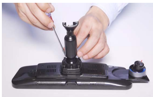
Шаг 6: Закрепите специальный кронштейн с помощью крепежных винтов.
