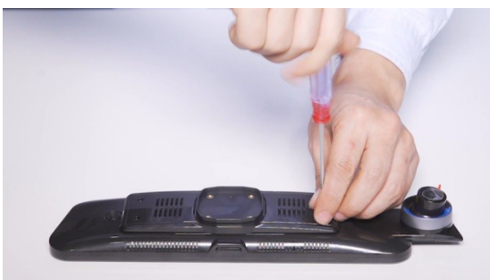
Шаг 5: Закрепите заднюю пластину с помощью с помощью крепежных винтов.
