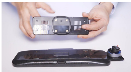
Шаг 4: Установите на видеорегистратор специальную заднюю пластину.
